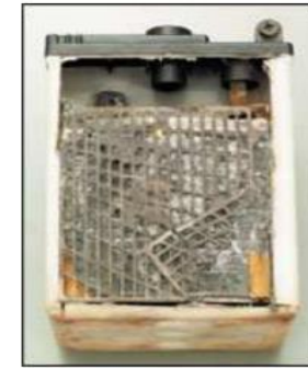
Placa de una batería rota (no recuperable).
