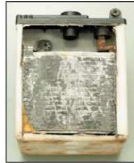
Placa de una batería sulfatada (recuperable).
